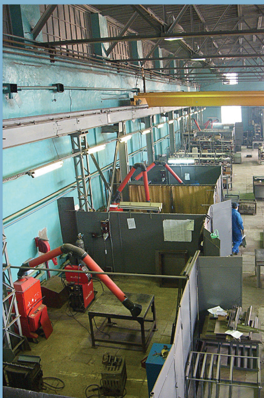
Электростатические фильтры ЭФВА-1,5-12 в комплекте с полноповоротным воздуховытяжным устройством ПВУ-4
