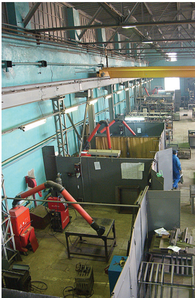
Рис. 16. Электростатические фильтры ЭФВА-1,5-11 в комплекте с воздуховытяжным устройством ПВУ-НК. Сборочно-сварочный цех – 10 постов.
