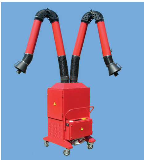
Рис. 4. Электростатический фильтр ЭФВА-1,5-12, передвижной, с вентилятором и двумя полноповоротным воздуховытяжным устройством ПВУ.
