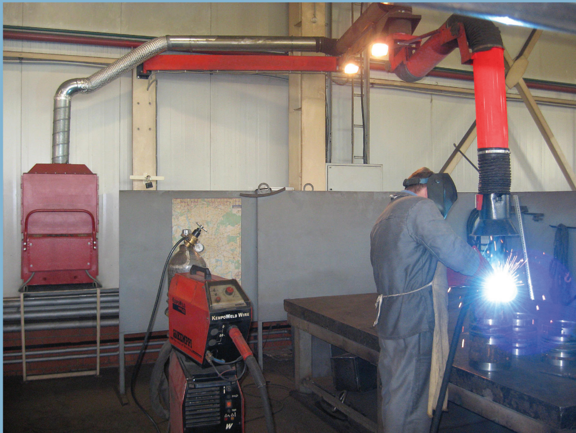
Электростатический фильтр ЭФВА-1,5-13 в комплекте с консольным воздуховытяжным устройством КПВУ на рабочем месте сварщика
